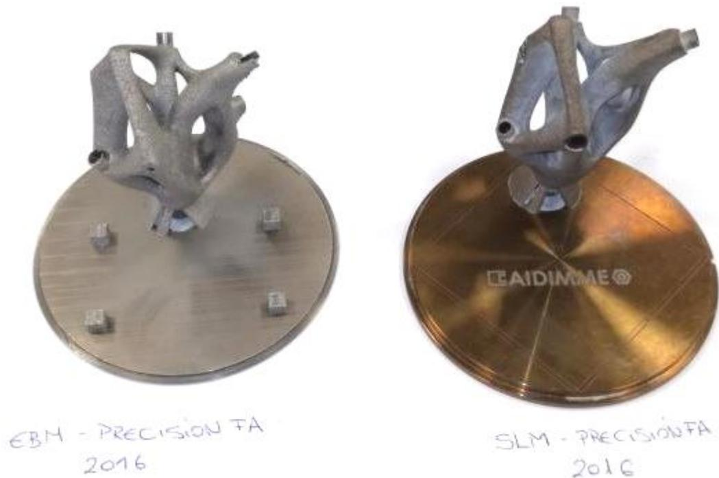
Figura 37. Piezas demos fabricadas en tecnología EBM (izquierda) y SLM (derecha) y posteriormente mecanizados diferentes orificios.
