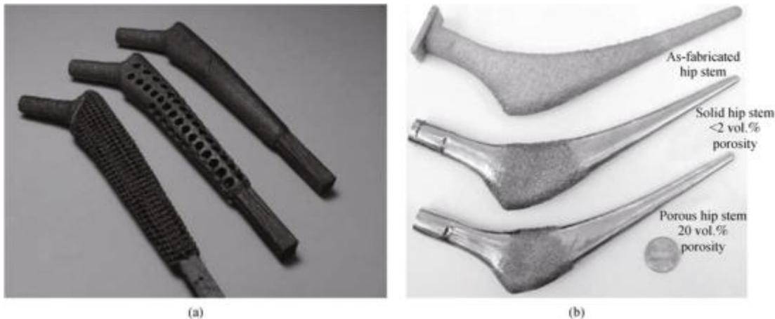
Figura 9. a) vástagos de cadera con malla, agujero y configuraciones sólidas fabricados utilizando EBM<sup>18</sup> (b) vástagos de cadera funcionales con porosidad diseñada (sin porosidad, <2% en volumen de porosidad y 20% en volumen de porosidad) fabricado usando LENS<sup>19</sup>
