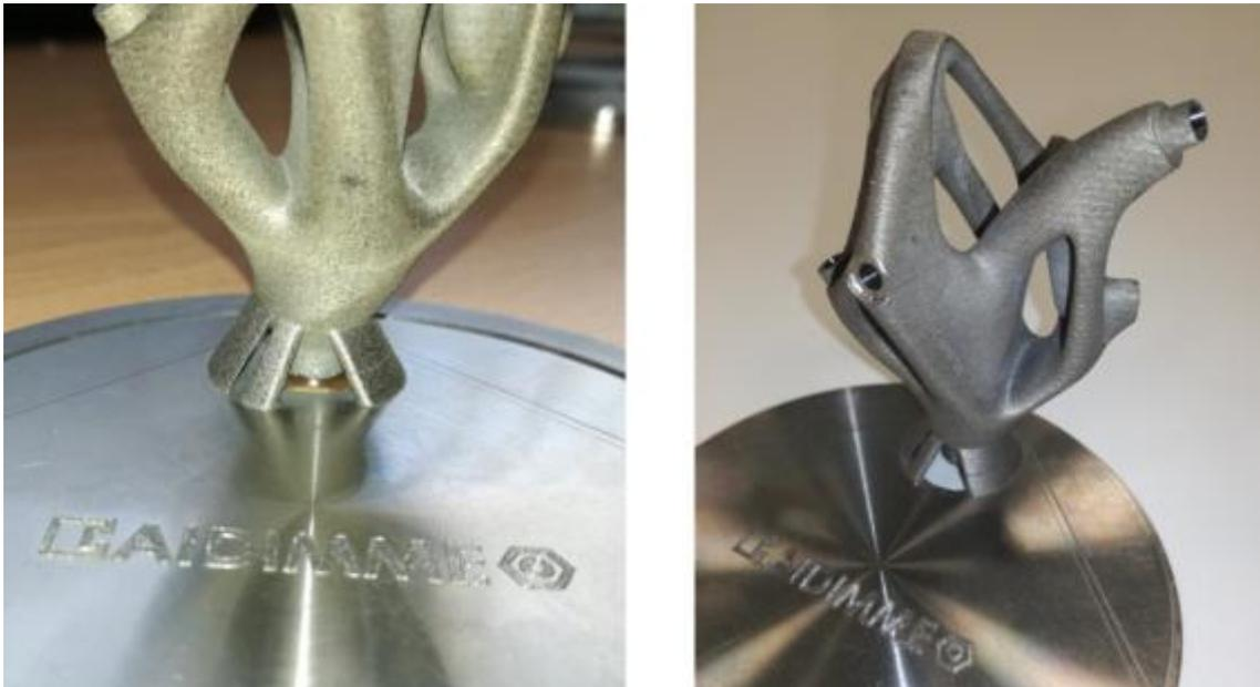
**Figura 36. Imagen de la pieza demo fabricada en SLM mecanizada. Los refuerzos no han sido mecanizados para poderse explicar y entender bien el nuevo sistema desarrollado.**
