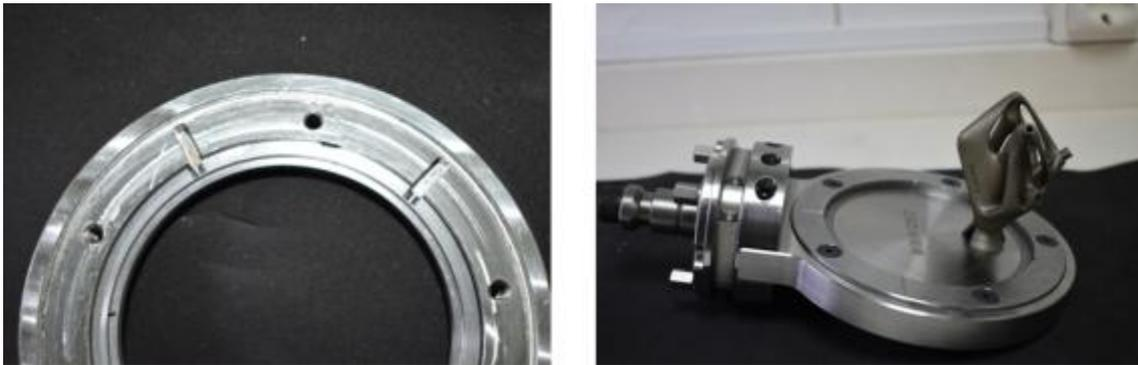
Figura 32. Marcas de posición en el soporte del plano y vista de la pieza descentrada.
